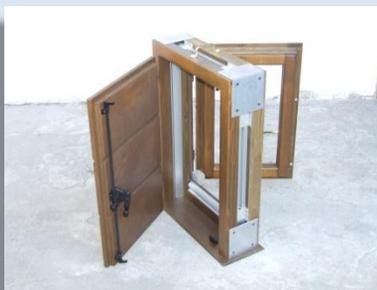
**Ante oscuranti in legno** a doghe o stecche, di pino impregnato tinto noce, verniciati trasparente (possibilità di altre finiture scelta extra capitolato), spessore telaio mm. 45 completi di ferramenta di portata e di chiusura (da definire in base alle caratteristiche dell'immobile).
